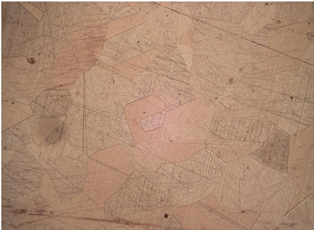
**Fig.14:** Imagem Cu-4,5 wt%Sb, aumento 100x. Tratamento à 300°C durante 8h.
