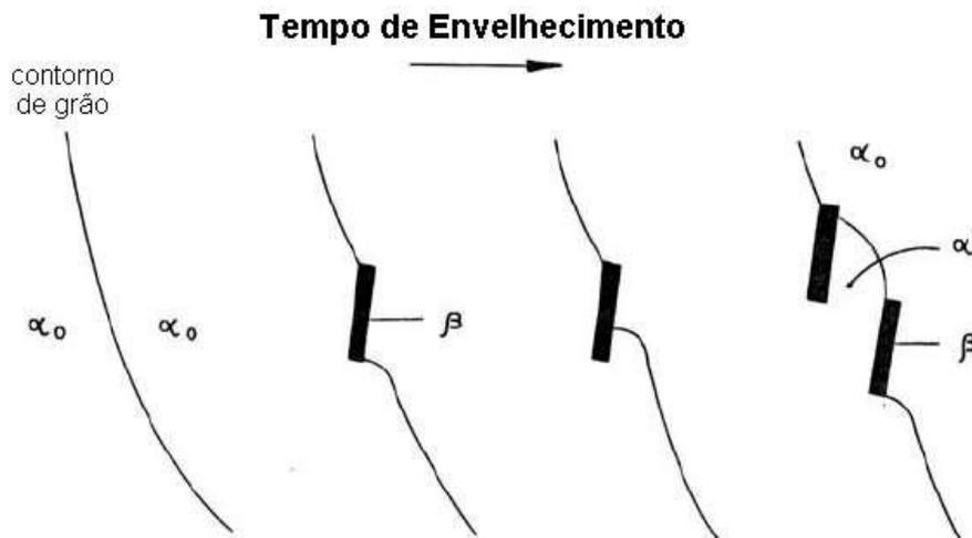
**Fig.12:** Mecanismo para a iniciação da precipitação descontínua a partir de um contorno de grão inicialmente ocupado.
