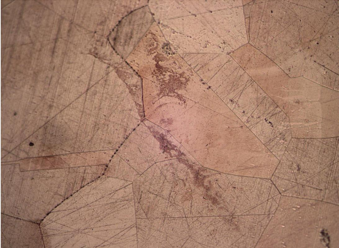
**Fig.8:** Imagem Cu-4,5 wt%Sb, aumento 200x. A temperatura de tratamento da liga de Cu-4,5 wt%Sb foi de 550°C durante 8h.
