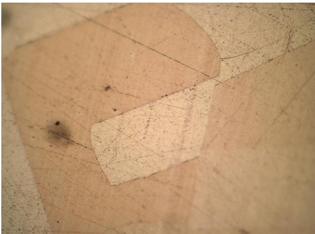
**Fig.16:** Imagem Cu-4,5 wt%Sb, aumento 500x.Tratamento à 300°C durante 8h.
